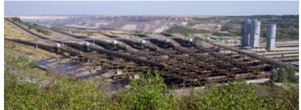
> Alle Förderbänder verbinden die Schaufelbagger mit dem Kraftwerk
