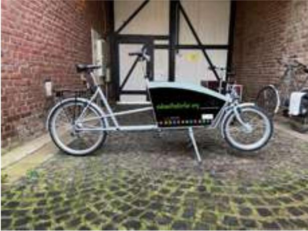
Abbildung 42: Lastenfahrrad Typ 1 - „FilibusPlus“
